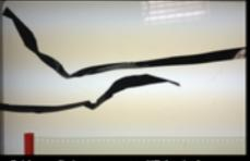
Evidenza di giunte su nastro X"; le pieghe sono douste allo scorretto reinserimento del nastro
